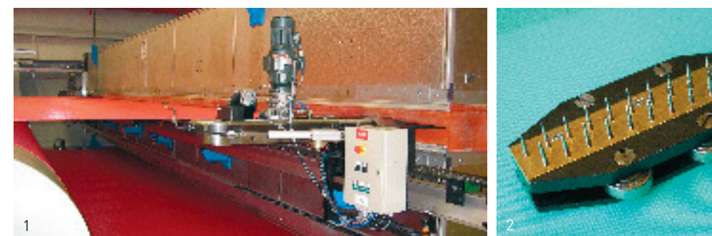
1. Fikseringsanlegg med tenter 2. Nålevogn til tenter
