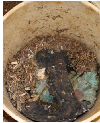
Elvekraftverk kan ha problemer store mengder med grove partikler som kvist, blader, barnåler og søppel. Bildet over viser innholdet fra tømningen av et gammelt filter som senere er erstattet med AG DDF Filterautomat.
