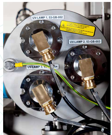
Lampetilkobling i Ex-sikker og servicevennlig konstruksjon
