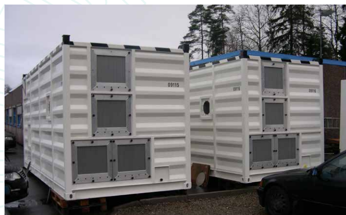
Klimakontainer med 4500 m 3 /t tørrluftmengde levert til Bilfinger.
