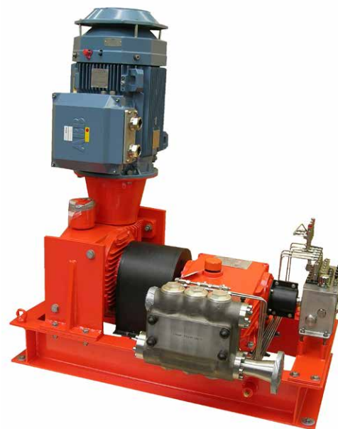
RAM Injeksjonspumpe levert Troll A og Ettrick FPSO
